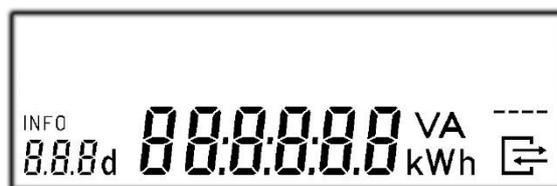
Die Software-Versionsnummer des metrologischen Teils wird mit der dazugehörigen Prüfsumme am Display angezeigt. Die Software-Version wird mit dem Index 1 angegeben.
